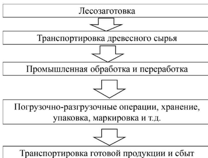
Рис. 3. Упрощенная схема производственных процессов лесопромышленного предприятия (по цепочке формирования затрат и добавленной стоимости)
