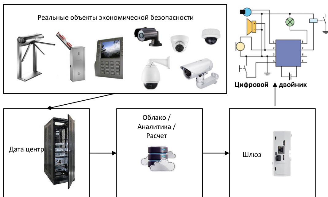
Рис. 2. Связь цифрового двойника с реальными системами
