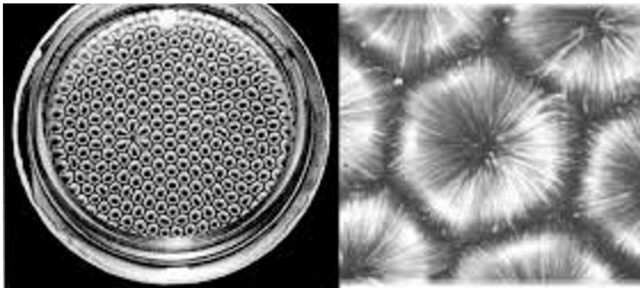
Рис. 1. Ячейки Релея-Бенара (справа – увеличение в 25 раз)
