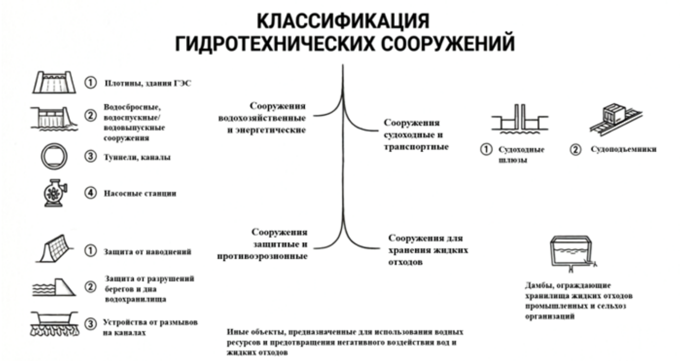
Рис. 1. Классификация гидротехнических сооружений
